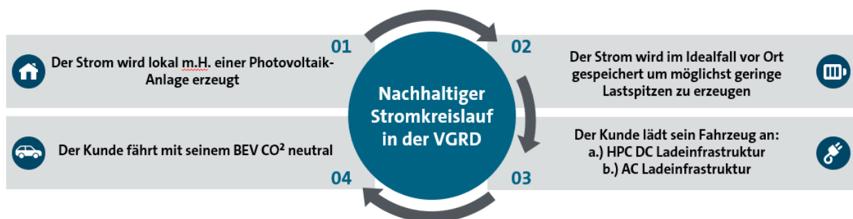
Abbildung 1: Nachhaltige Stromerzeugung in der Volkswagen Group Retail Deutschland durch eine Kombination aus Photovoltaik-Anlagen, Stromspeichern und öffentlicher Ladeinfrastruktur
